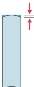
Die maximale Schüsselung (Lamelle bleibt nicht flach von Kante zu Kante liegen) darf gemäß DIN EN 13120 (in ihrer jeweils gültigen Fassung) den Höchstwert von  $C_u \leq 0,04 L$  nicht überschreiten, wobei  $C_u$  der Schüsselung in mm und  $L$  der Lamellenbreite entspricht.
