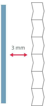
Bei transparenten Stoffen ist ein **Hinterlüftungsabstand von mindestens 3 mm** einzuhalten (Hinterlüftungsabstand = Abstand Glasscheibe zum Stoff).
