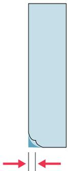
Die maximale Verdrehung (Winkelablenkung zwischen dem einen und dem anderen Ende der Lamelle) darf gemäß DIN EN 13120 (in ihrer jeweils gültigen Fassung) bei textilen Lamellen 5 mm/m Länge und bei festen Lamellen 2 mm/m Länge nicht überschreiten.
