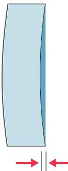
Die maximale Säbelförmigkeit  $C$  (Abweichung der Kante der Lamelle mit der Länge  $L$  von der Geraden, wenn die Lamelle auf einer Ebene flach ausgelegt wird) darf gemäß DIN EN 13120 (in ihrer jeweils gültigen Fassung) bei textilen Lamellen  $C=L$  nicht überschreiten (wobei  $C$  in mm und  $L$  in m zugrunde gelegt wird).
