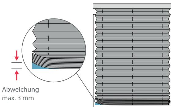
Die zulässige Toleranz der Faltenstruktur im Bereich des unteren Profils beträgt in jeder Position des Behanges 3 mm.
