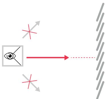
**Bild:** korrekter Blickwinkel zur Beurteilung des Schließverhaltens der Lamellen.
