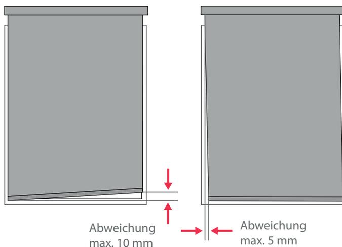
Höhe darf 10 mm nicht überschreiten. Dies gilt nach erfolgter, ortsfester Montage in Anlehnung an die DIN EN 13120 (in ihrer jeweils gültigen Fassung) bei vollständig eingefahrenem und ausgefahrenem Rollo sowie in mittlerer Stellung.
