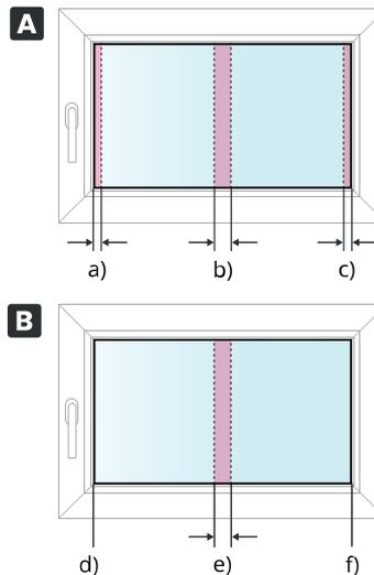
**A** Entstehung/Bildung von Lichtspalten bei gerader und leicht schräger Glasleiste.
