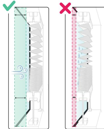
**Richtig:** Die empfohlene Glasleistentiefe (Abstand Glasscheibe zur Außenkante vom Rahmen) beträgt 25 mm (bei Dachfenstern 30 mm) – um einen Hitzestau und einen möglicherweise daraus resultierenden Glasscheibenriss zu vermeiden.
