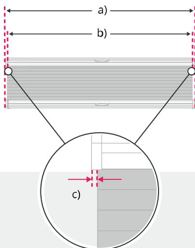
**Hinweis!** Die bestellte Breite ist die Gesamtbreite der Anlage. Der Stoff ist produktionsbedingt 3 mm schmaler als die Anlagenbreite.
