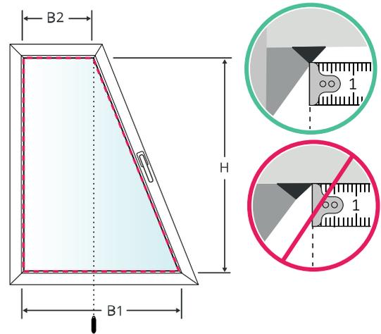
Ermitteln Sie für die Montage mit Befestigungsclips die Maße der Glasfläche inklusive der Gummidichtung.
